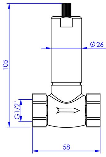
Débit / Flow rate : 21 l/min (sous 3 bars)
