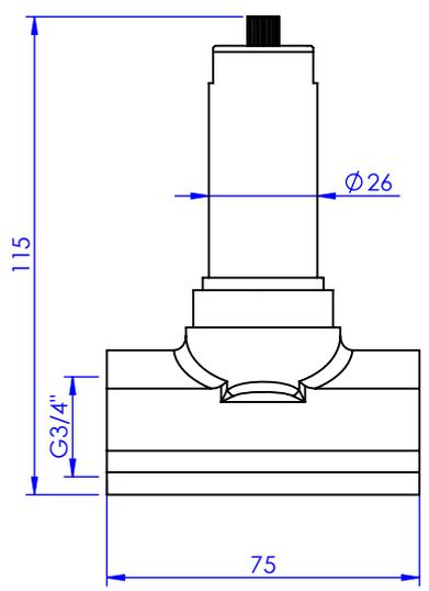
Débit / Flow rate : 36 l/min (sous 3 bars)
