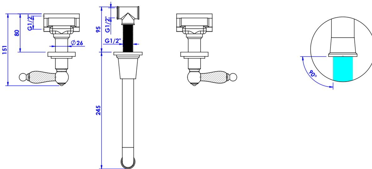
*$\phi$  de perçage et entraxe recommandés.
