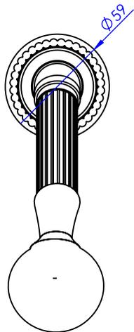
$\varnothing$  de perçage recommandé.
