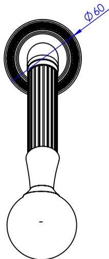
$\phi$  de perçage recommandé.
