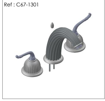
Débit / Flow rate : 181/min (sous 3 bars). Pression maxi / max pressure : 5 bars.
